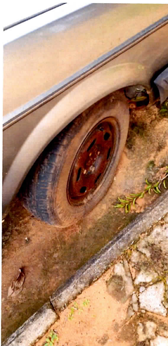
Foto 5: mostra a ferrugem nas rodas.
